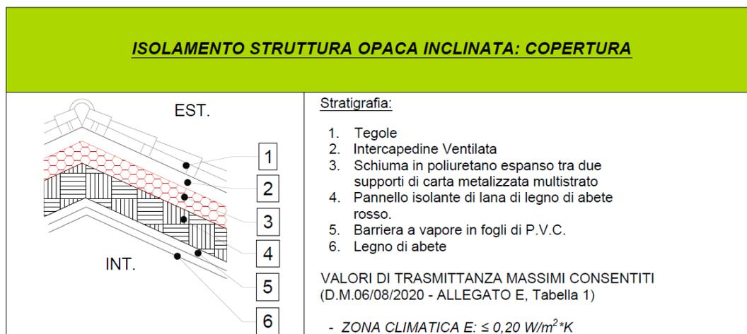
La caratteristica principale degli isolanti in poliuretano espanso è la loro bassa conducibilità termica che permette di ottenere elevate prestazioni isolanti con spessori ridotti. Limitare lo spessore e il peso del materiale isolante comporta importanti economie di cantiere e contribuisce a ridurre gli impatti ambientali dell'intervento.
